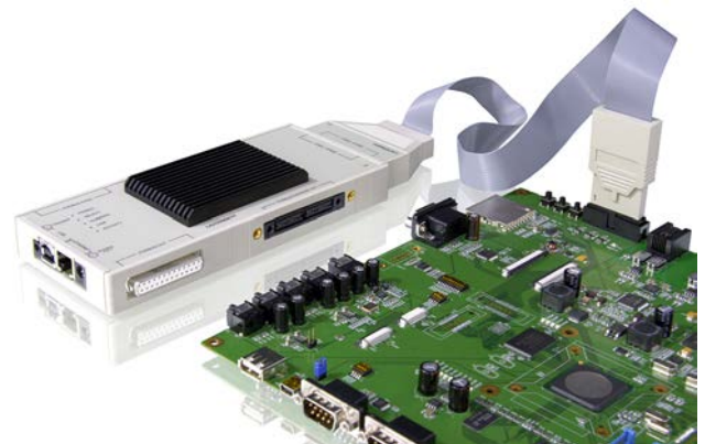
Bild 4. JTAG Debugger mit Zielsystem: So wird ein Hardware-Debugger an das Zielsystem angeschlossen.
